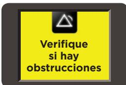
Si las lengüetas de silicona de la válvula de no retorno, situadas en el interior del puerto de entrada de la cámara, se han desplazado, la unidad puede generar una alarma de «Verifique si hay obstrucciones». Vuelva a colocar las lengüetas de silicona en la posición correcta mediante una herramienta no afilada, o sustituya la válvula de no retorno por 90OPT911.
