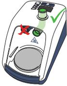
Este paso de limpieza tiene como objeto eliminar toda la contaminación del codo de salida (entre el puerto de la cámara de la derecha y el puerto de conexión del tubo respiratorio calentado) antes de llevar a cabo el ciclo de desinfección. Es importante efectuar este proceso de limpieza en primer lugar para garantizar que el ciclo de desinfección sea efectivo. Asimismo, es importante limpiar las demás superficies externas de la unidad.
