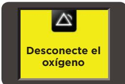
Si se detecta oxígeno durante la desinfección, sonará la alarma de «Desconecte el oxígeno» y el ciclo de desinfección se detendrá. Desconecte el oxígeno, apague la unidad y reinicie el ciclo de desinfección.
